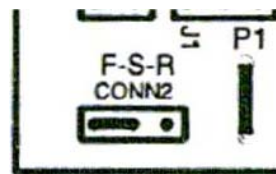
Σχήμα 6 : Jumper Ρύθμιση αλλαγή της φοράς λειτουργίας κινητήρα.
